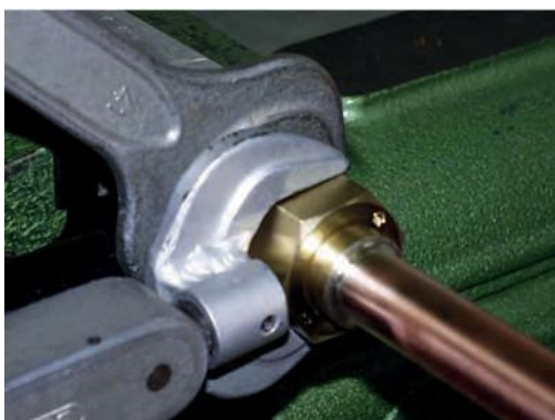
11. Крепко и быстро затянуть зажимную гайку с усилием, указанным в таблице
