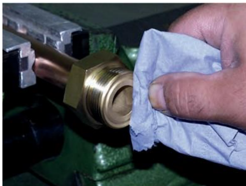
8. Перед сборкой очистить шпунт и канавку детали DILO
