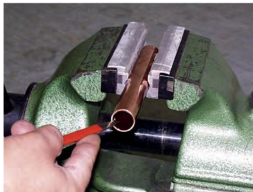
2. Снять заусенцы внутри и снаружи
