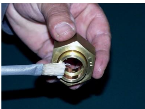
5. Наложить флюс на части, которые будут подвергаться пайке
