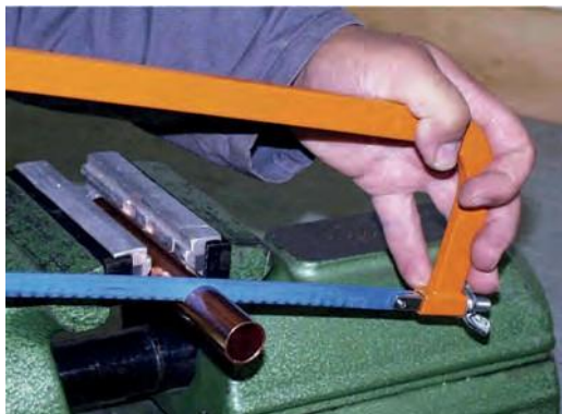
1. Отрезать трубку под прямым углом
